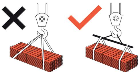
Разгрузка пачек с профилированными изделиями и металлочерепицей выполняется в заводской упаковке при помощи подъёмной техники с мягкими стропами, при длине пачек до 5 метров. Если длина упаковок составляет более 5 метров, то разгрузка выполняется с использованием траверсы.
