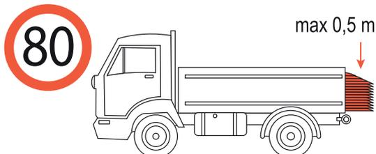
Транспортировка профилированных листов, металлочерепицы осуществляется исправным транспортным средством с ровной, прочной и чистой поверхностью кузова. Во время транспортировки необходимо обеспечить защиту продукции от случайного перемещения и механического повреждения. Длина кузова автомобиля должна быть такой, чтобы упаковка с продукцией выступала за задний борт кузова автомобиля не более, чем на 0.5м, в этом случае листы должны быть полностью помещены на жёсткую деревянную платформу (поддон).
